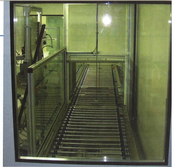
Mit einer Verkettungseinheit werden die gereinigten Teile über die Reinraumschleuse in den Montagebereich transportiert.
